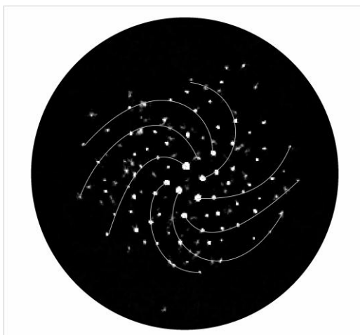
Рис. 6. Экспериментальное распределение перфораций при искровом разряде в неупорядоченной среде (газе)
