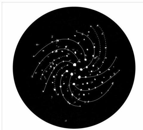
Рис. 7. Экспериментальное распределение перфораций при искровом разряде
