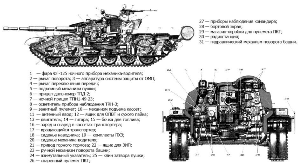
Рис. 7. Компоновка танка Т-72 (СССР)
