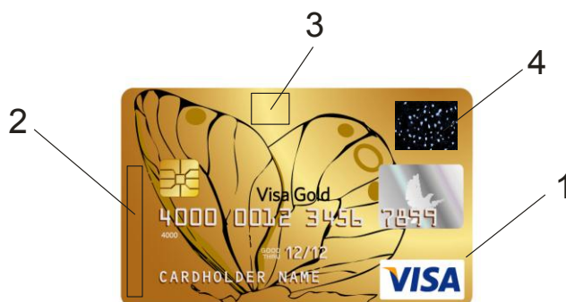
Рис. 9. Банковская карточка: 1 - банковская карточка, 2 - магнитная лента, 3 - чип, 4 - неповторимый набор электроразрядных пятен
