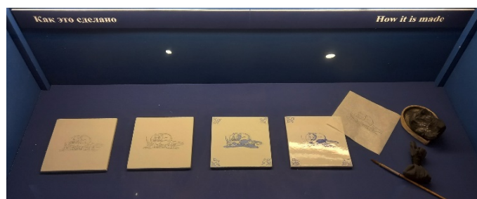
Рисунок 2. Этапы изготовления керамической плитки в голландском стиле в экспозиции Музея архитектурной керамики «Керамарх», 2023 г. Фото Н. В. Родионовой
