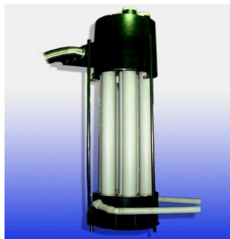
Рис. 4. Модуль по очистке технологических газов В-20
