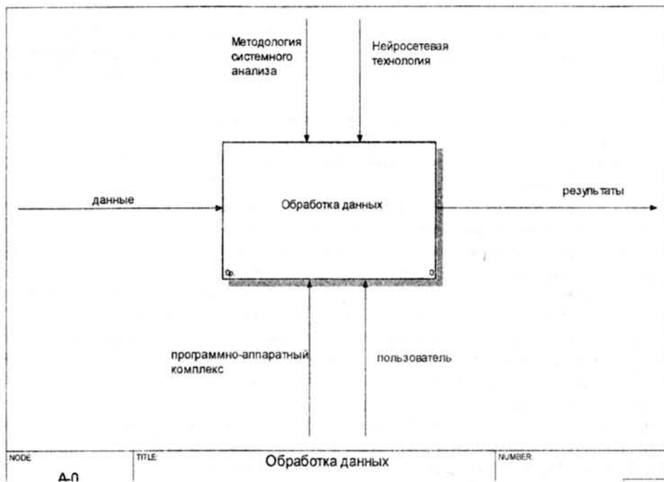
Рис. 1. Контекстная диаграмма обобщенной модели обработки данных с помощью нейронных сетей
