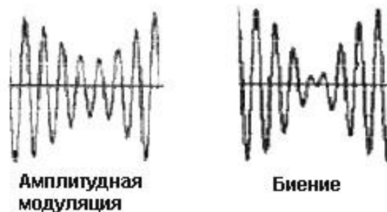
Рис. 4. Характеристики амплитудной модуляции и биения
