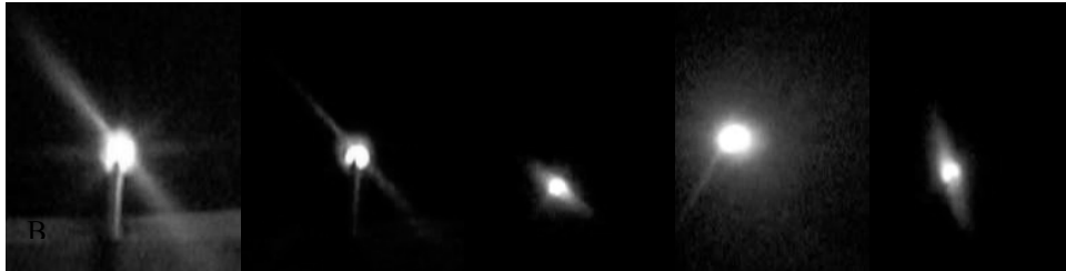
Рис. 8. Формы электрического разряда при осевом расположении видеокамеры (вдоль оси разряда)
