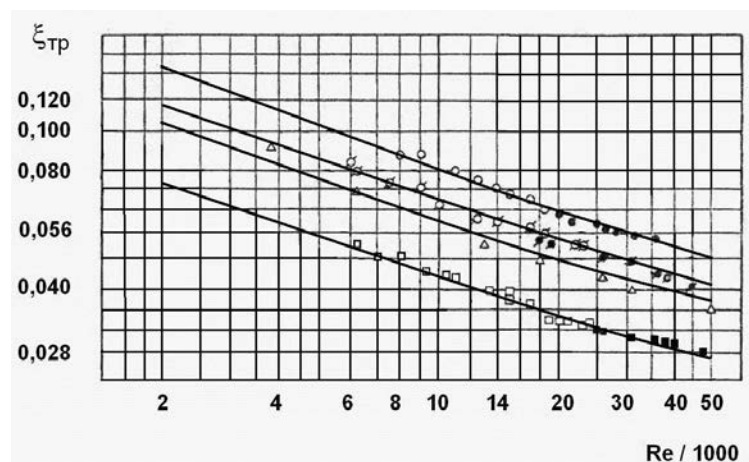
Рис. 1. Сопоставление расчётных и экспериментальных значений коэффициента гидравлического сопротивления трению \xi_{тр} в трубе со скрученной при классических граничных условиях в широком диапазоне определяющих параметров:
