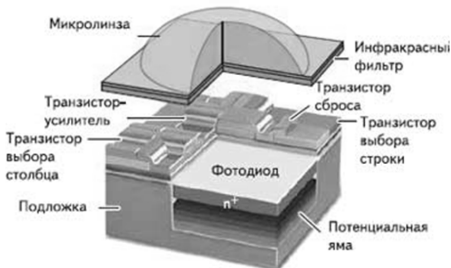
Рис. 2. Структура фотодиодной КМОП-ячейки
