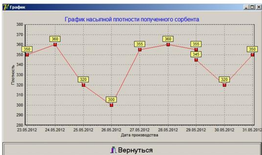
Рис. 5. График изменения насыпной плотности полученного сорбента органических соединений
