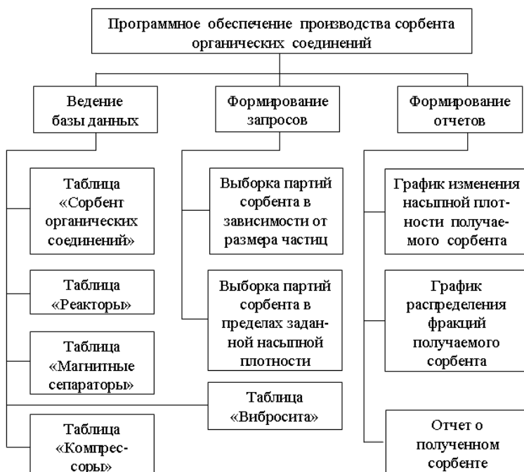
Рис. 2. Структурная схема подпрограммы «Производство сорбента органических соединений»
