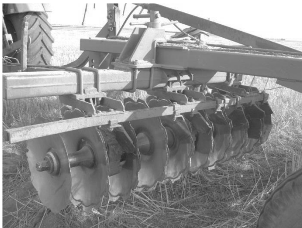
Рис. 3. Общий вид секции дисковой бороны АКРП с дисками, упрочненными методом ЭО, установленными для проведения эксплуатационных полевых исследований
