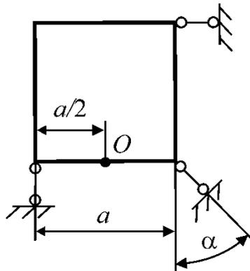
Рис. 2. Плоская стержневая система
