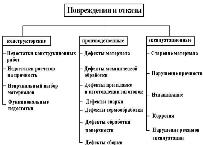
Рис. 2. Виды повреждений и отказов авиационной техники
