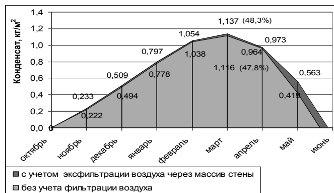
Рис. 5. Количество влаги, конденсирующейся в слое поропласта (в скобках приведена весовая влажность материала)
