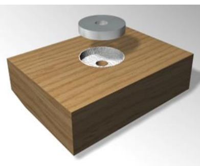
Рис 3. Последовательность клеивания стальной шайбы в деревянный образец: а) образец с гнездом, заполненным клеем; б) клеивание шайбы в гнездо деревянного элемента; в) готовая заготовка с клееными в неё шайбами
