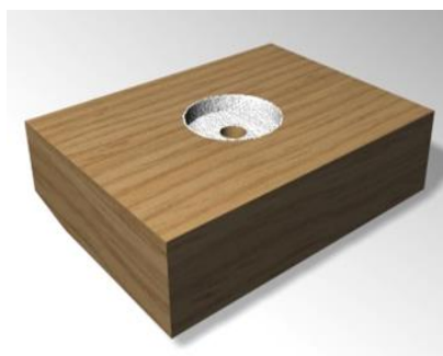
Рис 3. Последовательность клеивания стальной шайбы в деревянный образец: а) образец с гнездом, заполненным клеем; б) клеивание шайбы в гнездо деревянного элемента; в) готовая заготовка с клееными в неё шайбами
