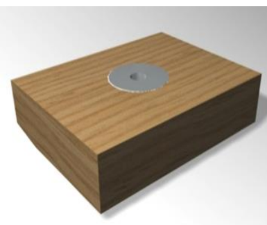
Рис 3. Последовательность клеивания стальной шайбы в деревянный образец: а) образец с гнездом, заполненным клеем; б) клеивание шайбы в гнездо деревянного элемента; в) готовая заготовка с клееными в неё шайбами
