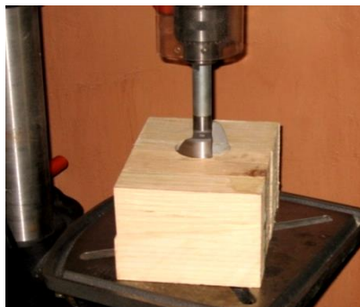
Рис 1. Процесс высверливания гнезда
