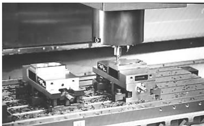
Рис. 1. Одновременная обработка двух деталей на станке с ЧПУ
