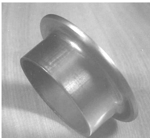
Рисунок 4. Фланец, раскатанный из трубной заготовки диаметром 219,1 мм (толщина стенки – 7,8 мм, толщина фланца – 9,5 мм, ширина фланца – 31 мм, радиус перехода от трубной части к фланцевой R=12,7 мм, материал AISI 316)
