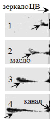
Рис. 3. Кинокадры маслоподдачи через верхний пояс каналов
