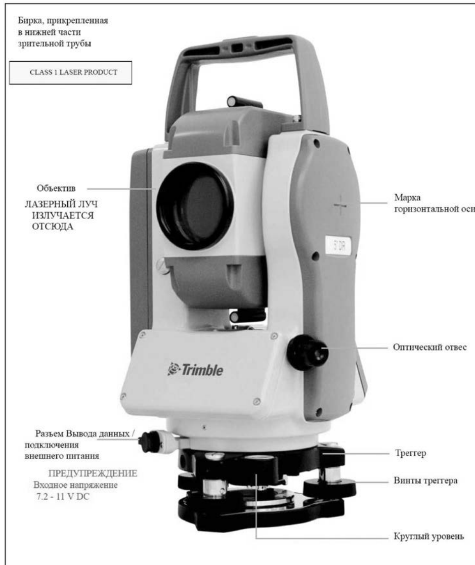
Рис. 2. Внешний вид тахеометра Trimble M3, сторона 2
