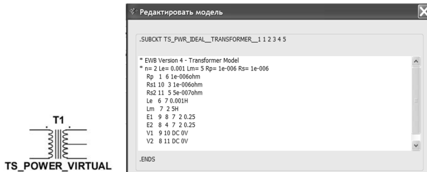
Рис. 5. Изображение и описание макромодели виртуального силового трансформатора TS_POWER_VIRTUAL
