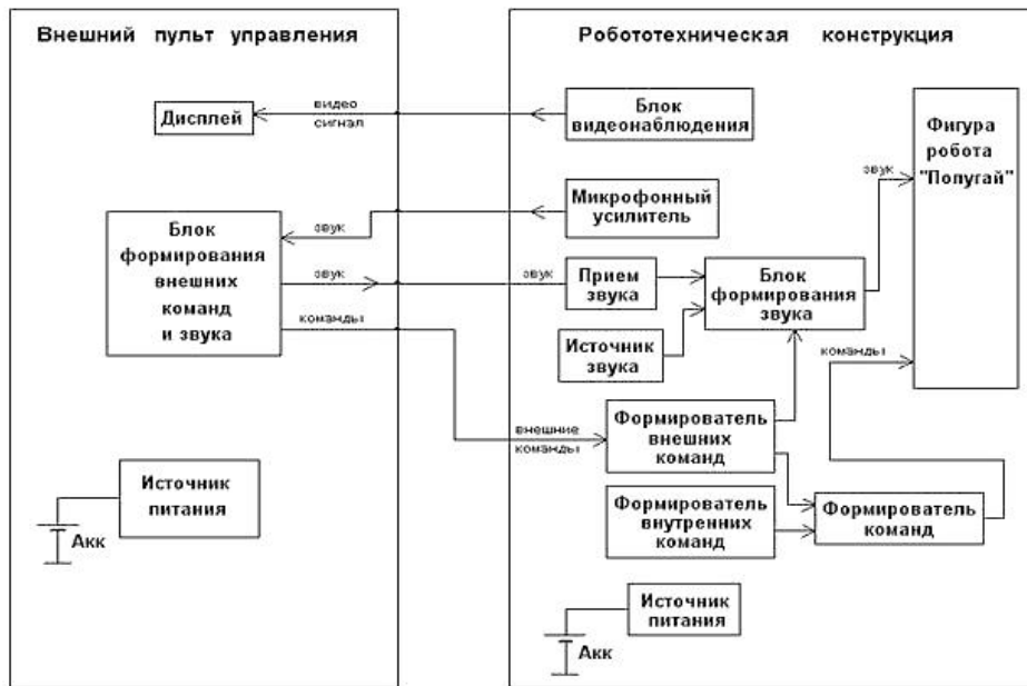
Рис. 1. Структурная схема робототехнической конструкции «Попугай»
