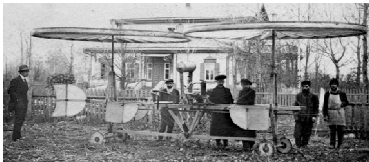
Общий вид пилотируемого геликоптера Н. И. Сорокина. г. Новгород–Северский. 1910-е гг. Третий слева Н. И. Сорокин
