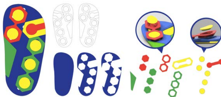
Рис. 3. Конструкция подошвы детской обувной пары, спроектированная с использованием методов комбинаторного формообразования (унифицированный элемент – пятиугольник)
